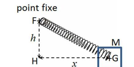
1) Le vecteur tension  $\vec{T}$  du ressort sur la masse M a pour norme  $k \times a$ , (k : raideur du ressort).
